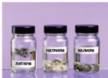
Алкалните метали се чуваат во масло поради нивната голема реактивност.
