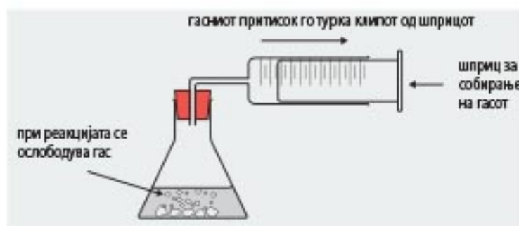
Апаратура потребна за мерење на брзината на реакцијата преку мерење на волуменот на ослободениот гас.
