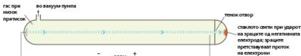
Томсоновата апаратура со којашто го открил електронот.
