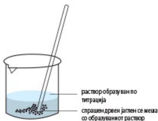
Одземање на бојата на индикаторот од растворот со додавање спрашен дрвен јатен кон образуваниот раствор. Ова е услов за да може да се издвои добиената сол при оваа реакција.
