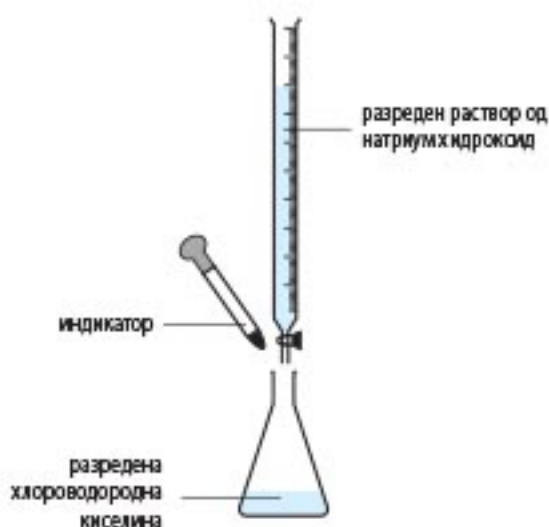
Титрација на хлороводородна киселина со натриум хидроксид во присуство на индикатор.
